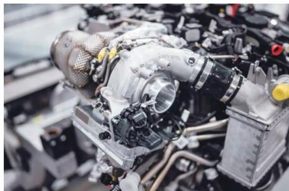
過渡状態を電動で補うことのできる電動アシストターボでは大径化と動翼形状の最適化により高効率化が可能
